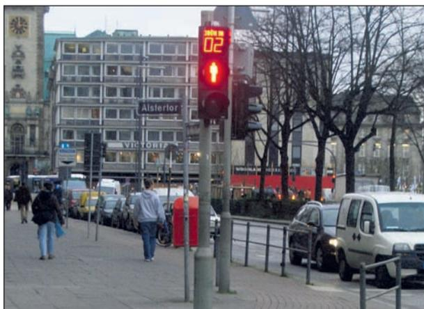
**Bild 3-11:** Fußgängersignalanlage mit Restrotanzeige (Grün in... Zeitangabe in Sekunden) in Hamburg
