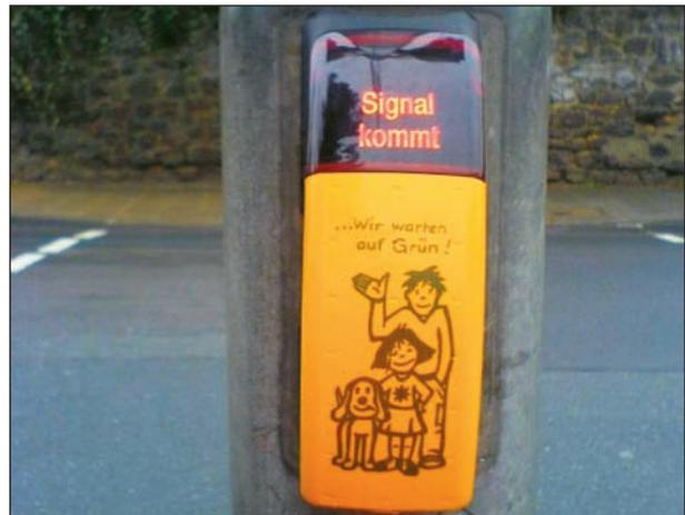
**Bild 3-3:** Fußgänger-LSA mit Anforderungstaster mit Bestätigung am Taster
