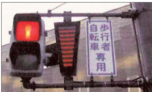
**Bild 3-19:** Anzeige der verbleibenden Sperr- und Freigabezeit in Balkenform in Tokio (BOLTZE, KITTLER, NAUKAMURA 2008)
