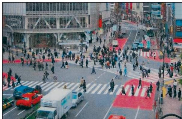
**Bild 3-28:** Rundum-Grün mit diagonalem Queren für Fußgänger in Japan (BOLTZE, KITTLER, NAKAMURA 2008)
