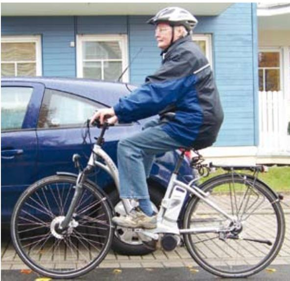
Abbildung 7: Pedelec – Elektrofahrrad (Foto Fürst)
