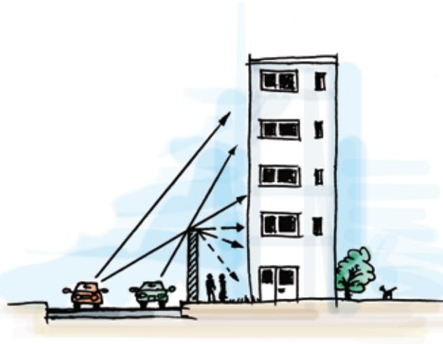
Abbildung 23: Der untere Bereich hinter der Lärmschutzwand ist geschützt, nach oben hin nimmt die pegelmindernde Wirkung ab, der obere Bereich mit Sichtverbindung hat keinen Schutz
